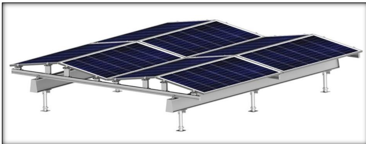
Rysunek 2 Poglądowe ułożenie paneli w układzie wschód - zachód
